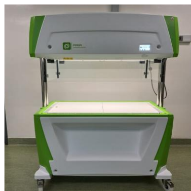
Estación de cambio Techniplast
